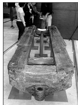
L'affût en bois d'un canon pivotant du CSS Alabama (photo Oliver Semmes)
